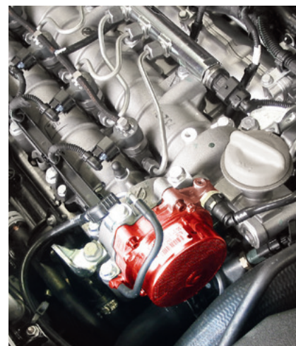
欧宝威达 C (Opel Vectra C) 中的真空泵 (高亮显示)
