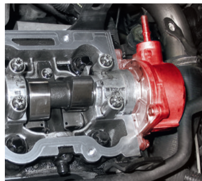
欧宝威达 B（Opel Vectra B）的真空泵和凸轮轴（高亮显示）
